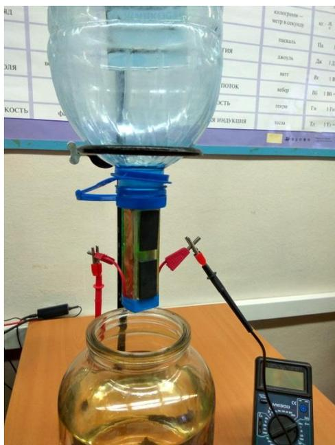
Рис. 1. Модель МГД-генератора
