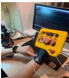
Фото 1. Рукоятка с беспроводным соединением с блоком управления манипулятором
