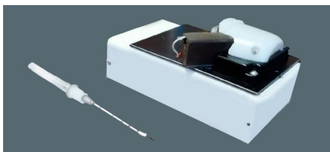
Рис. 1. Самодельный электрический термометр
