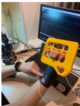
Фото 1. Рукоятка с беспроводным соединением с блоком управления манипулятором
