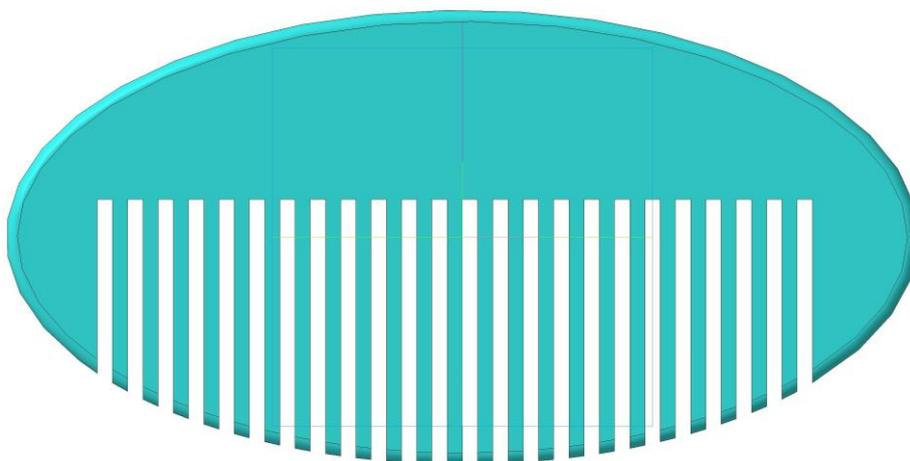
*Размеры: Ширина – 120 мм, высота – 60 мм, толщина - 3 мм, высота центрального зуба – 35 мм, толщина зуба – 2 мм, расстояние между зубьями – 2 мм, края скруглить.*
