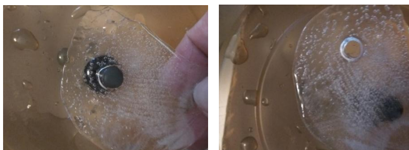
Рисунок 5. Воздействие ультразвука непосредственно на ледовую поверхность
