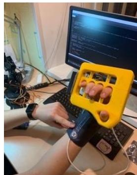
Фото 1. Рукоятка с беспроводным соединением с блоком управления манипулятором
