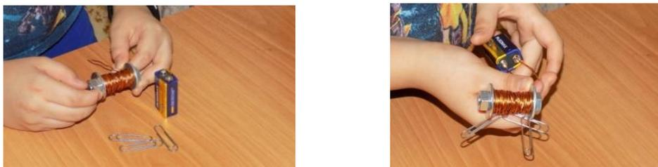
Рис. 2. Проверка работоспособности созданного электромагнита
