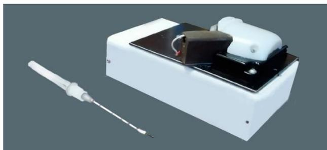
Рис. 1. Самодельный электрический термометр
