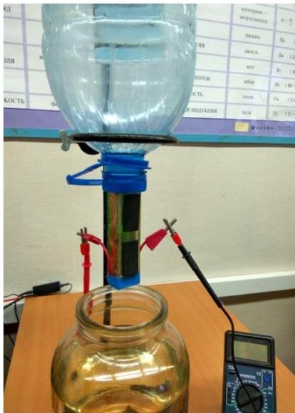
*Рис. 1. Модель МГД-генератора*
