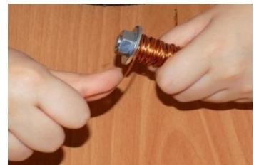
Рис. 1. Сборка электромагнита
