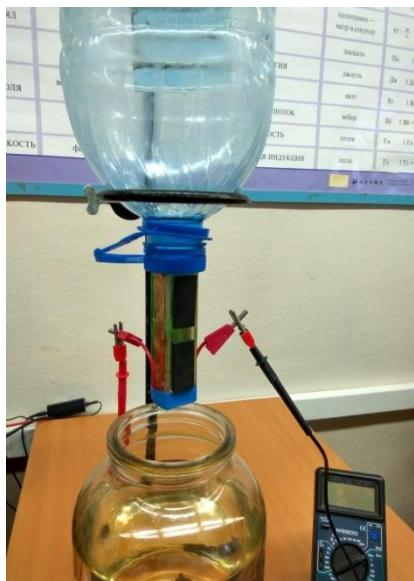
*Рис. 1. Модель МГД-генератора*
