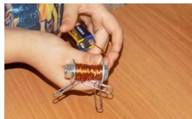
Рис. 2. Проверка работоспособности созданного электромагнита
