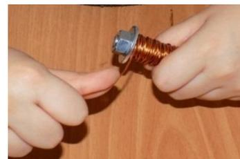
Рис. 1. Сборка электромагнита
