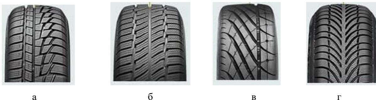
Рис. 1. Виды рисунков протекторов: а – асимметричный ненаправленный, б – асимметричный направленный, в – симметричный направленный, г – симметричный ненаправленный
