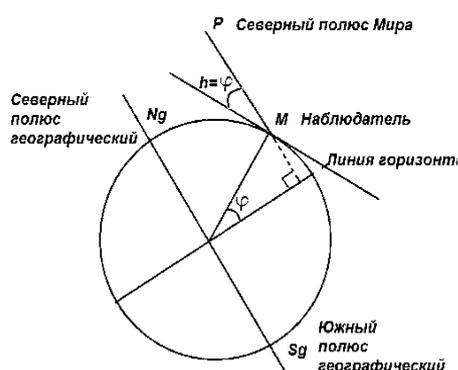
Рис. 1. Определение географической широты места по Полярной звезде
